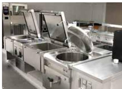
Beispielhaft für höchste Ergonomie- und Hygieneansprüche sind flächenbündig in die dicht verschweißten Deckplatten eingesetzte Kochfelder sowie große, reinigungsfreundliche Radien und seitliche Ablaufrinnen. Überdurchschnittliche Schutzarten gewährleisten die permanente Geräte- und Betriebssicherheit.
