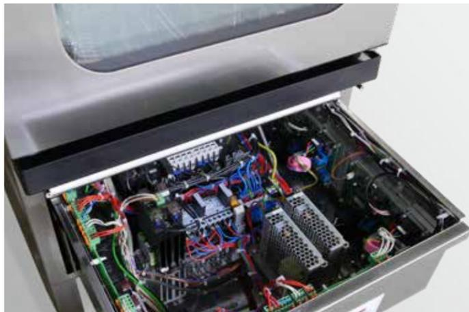
Installation und Wartung - so einfach, wie noch nie, denn bei dem neuen SpaceCombi Team und Magic Team sitzt die Technik in einer Schublade. Diese kann ganz einfach von vorne geöffnet und geschlossen werden. Und das mit nur einem Servicemitarbeiter.
